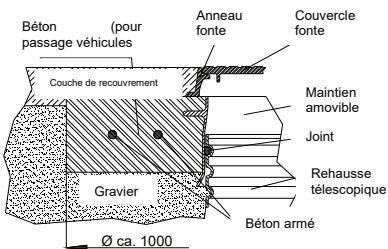
**La charge dégagée par une surface roulante ne doit en aucun cas être transférée sur la cuve.**
