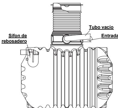
Todos los dispositivos de absorción, presión y control deben instalarse en el tubo de entrada que se coloque en línea recta y con pendiente al depósito, sin flexiones. Los codos requeridos deben formarse en angulos de 30°. Mantenga el tubo de entrada tan corto como sea posible.
