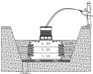
Bei Installation der Behälter unter Flächen die mit **PKW befahren** werden muss eine ca. 200 mm bis 300 mm hohe **Schotter-Tragschicht** über dem Behälter eingebracht werden. Die Fläche der Schotter-Tragschicht sollte der Größe der Sohle der Baugrube entsprechen.
