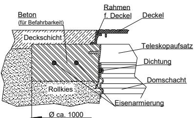
**Auftretende Lasten dürfen auf keinen Fall direkt auf den Tank übertragen werden.**
