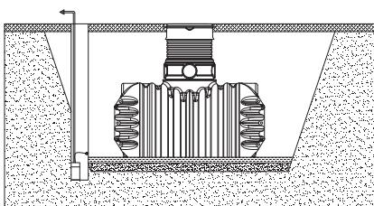
Dans le cas où la cuve serait installée plus profondément qu'indiqué dans le tableau, il est impératif d'évacuer les eaux de la nappe phréatique par un drainage relié à un tuyau de dérivation adapté.
