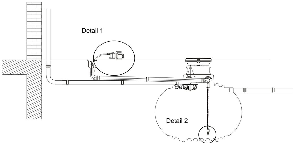
**Achtung:** Der Abstand zwischen Wassersteckdose und Erdtank ist durch die Länge des Saugschlauches begrenzt – max. Ansauglänge der Pumpe 12,5 m!
